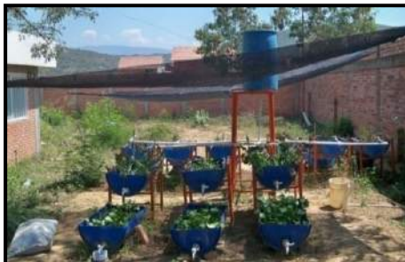
Figura 2. Montaje del humedal con los tres sistemas con las diferentes especies vegetales.
